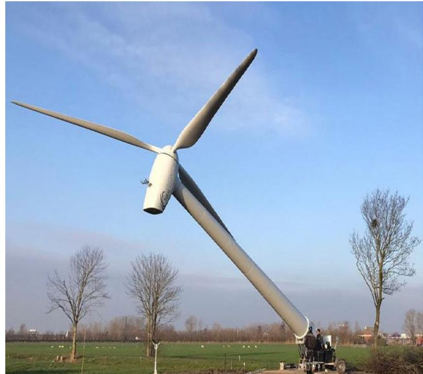
Eolienne 25 kWp avec mat hydraulique pour réduire les coûts de montage et de maintenance
